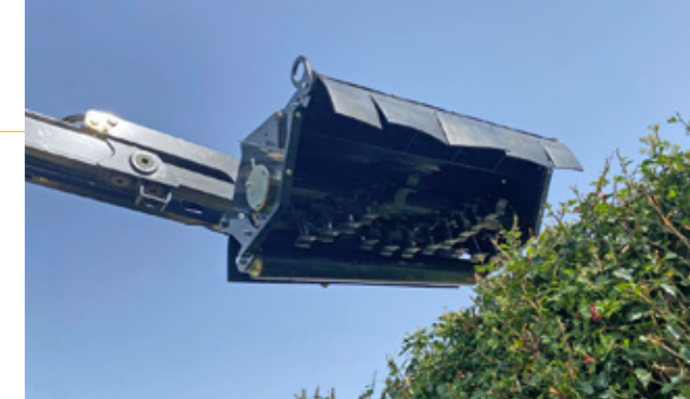
▲ Powerdrive 120 Schlegelkopf mit Doppelspiralschlegelanordnung
