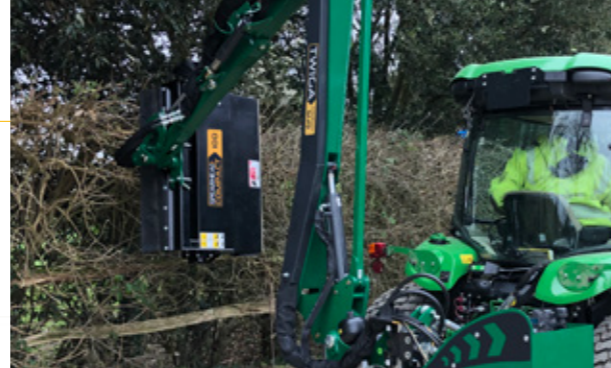
▲ TWIGA Compact avec broyeur à fléaux Compact 100
