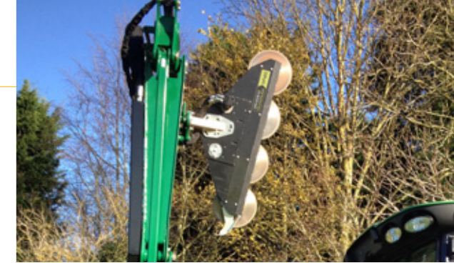
▲ Élagage avec le lamier SP20 Quadsaw
