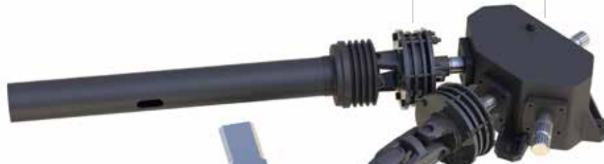
ЗАЩИТА ПРИ ПОМОЩИ ПРЕДОХРАНИТЕЛЬНОЙ МУФТЫ
